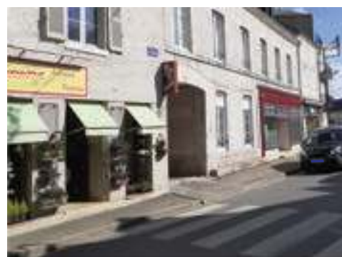
Un trottoir trop étroit, un revêtement en mauvais état ainsi qu'une absence d'abaissement de trottoir au niveau du passage piéton pouvant rendre les déplacements difficiles pour certains piétons
